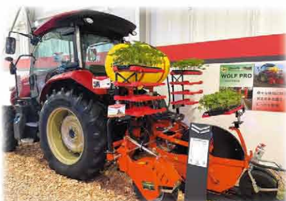
マルチをしながら移植が出来るヤンマー「チェッキアンドマグリ」
