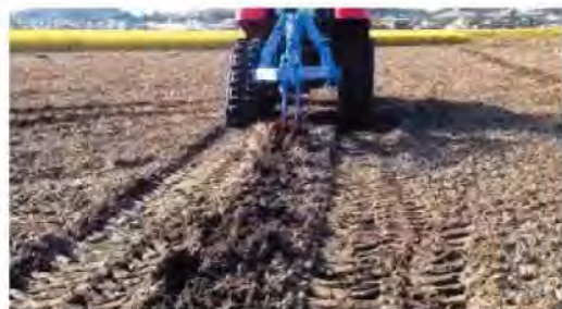
収穫後サブソイラ施工で排水対策
