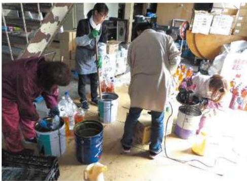
廃油に苛性ソーダを加えて攪拌する様子
